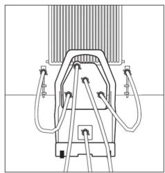
desconectado el radiador) usando adaptadores BSP apropiados de ½" o ¾" para conectar a las válvulas. Las válvulas del radiador deben estar cerradas para aislar la bomba de lavado del
