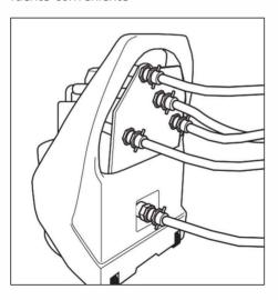
cuando un grifo monomando dificulta la conexión de una manguera. Se deben tomar las precauciones normales durante el trabajo en cualquier sistema de calefacción y es prudente colocar la bomba sobre un suelo impermeable o una bandeja de contención.
